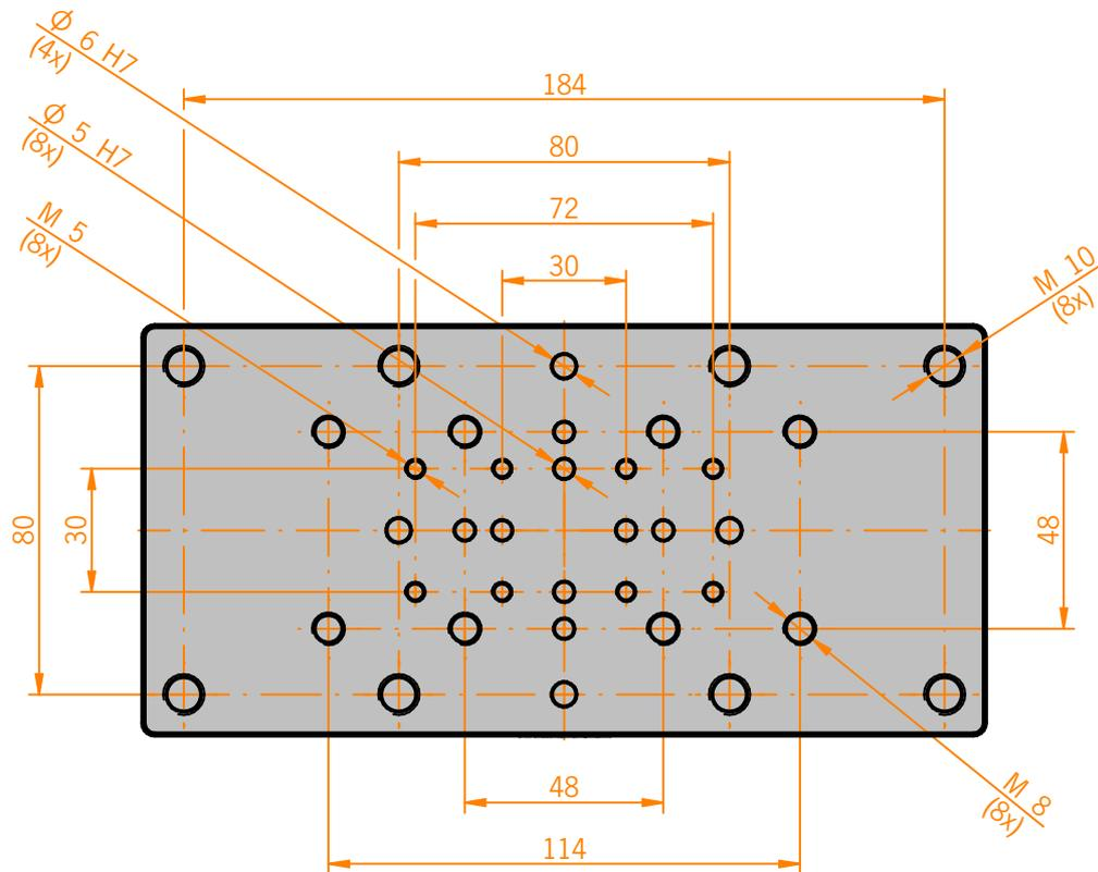
Anschraubbohrbild passend für:
