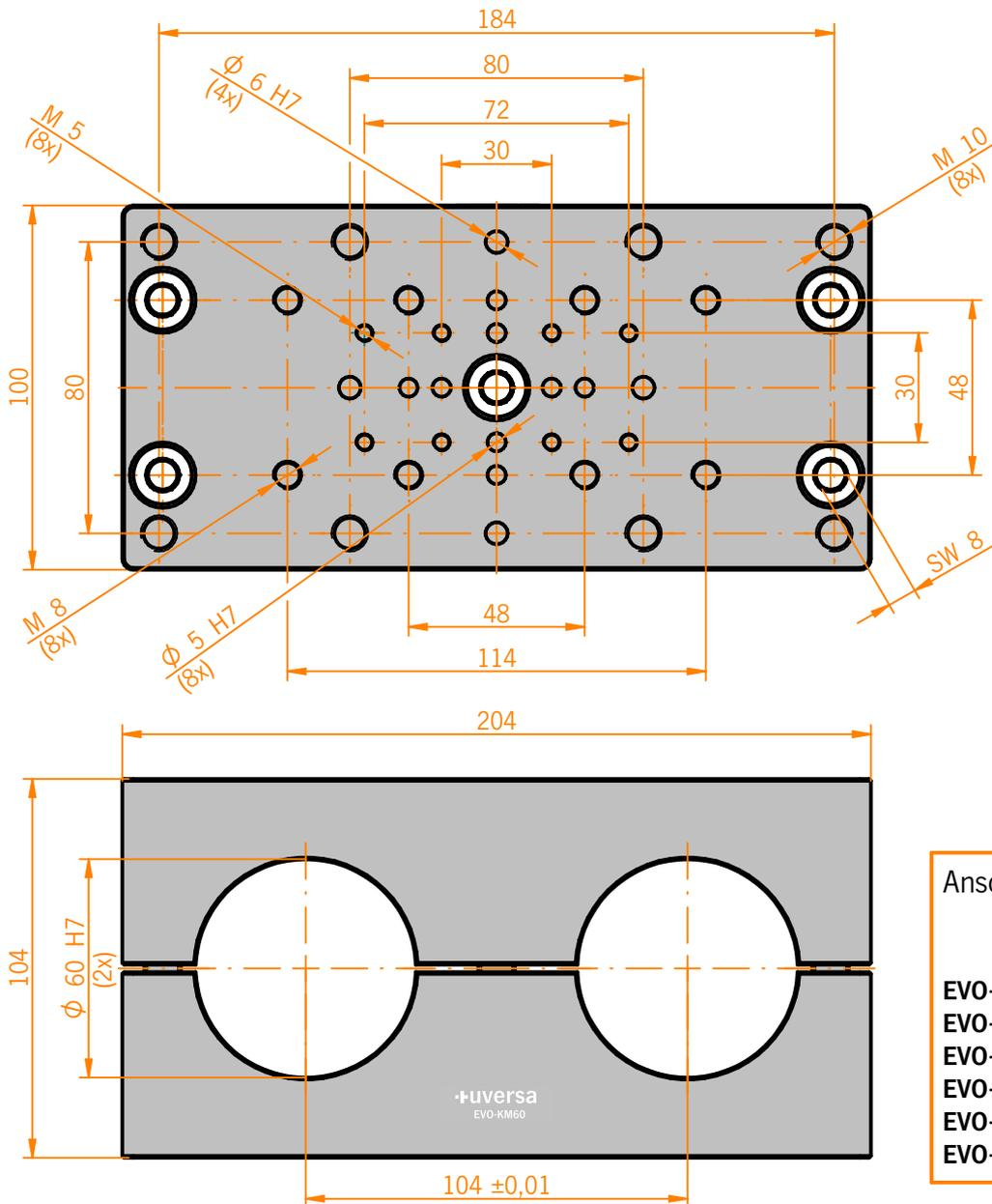
Anschraubbohrbild passend für:
